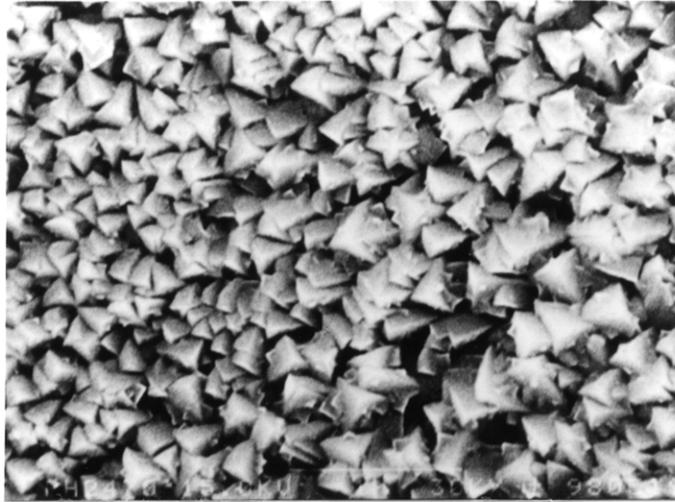
図 5-3 TiN膜表面のSEM写真 (TiN膜厚さ : 5  $\mu\text{m}$ )
