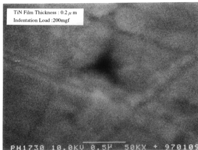
図 5-25 くぼみのSEM写真 (TiN膜厚さ 0.2 μ m, 押込み荷重 200mgf の場合)
