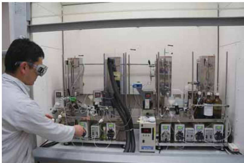
(R)-ロリプラムのフロー法による合成装置。4つのカラムを通過し8段階の化学反応が進行する。
