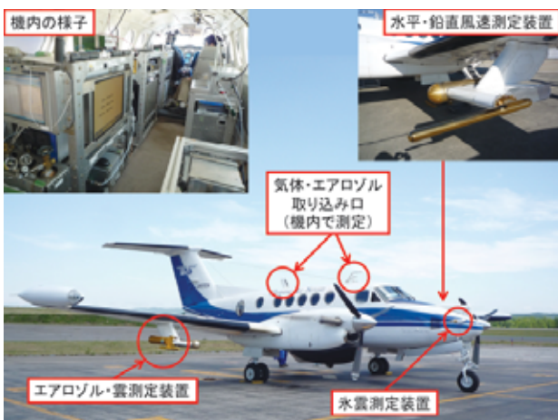
2009年と2013年の観測で使用した航空機。機内には世界最先端の測定機器がずらりと並び、パイロット2名と研究者2名を乗せて、未知の現象の解明に挑む。
