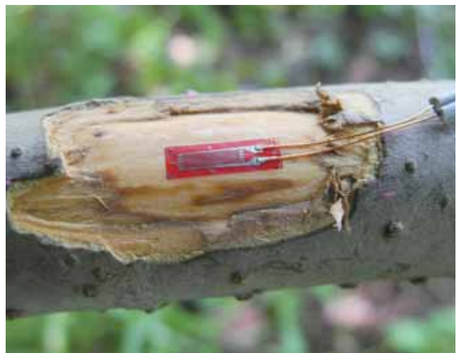
図2：建物の写真が撮りたくてカラマツに登ったわけではない。樹木には自重や風などによる力学ストレスがかかっている。このストレスと樹形との関係を明らかにするためにカラマツに登り、カラマツの下から上までこの写真のように歪みゲージを取り付けた。これによって幹や枝に生じる応力を知ることができるようになった。樹木の個体全体に多数の歪みゲージを取り付け、応力をくまなく測定したのは世界で初めてのことだ。ゲージのメーカーは生きた木への取り付けという想定外の使用に困惑していたが、良い方法を考案してくれた。測定は現在も続いていて、結果を見るのが毎日楽しい。樹木の太い幹の場合、風速100m/秒でも折れることはないようだ。
