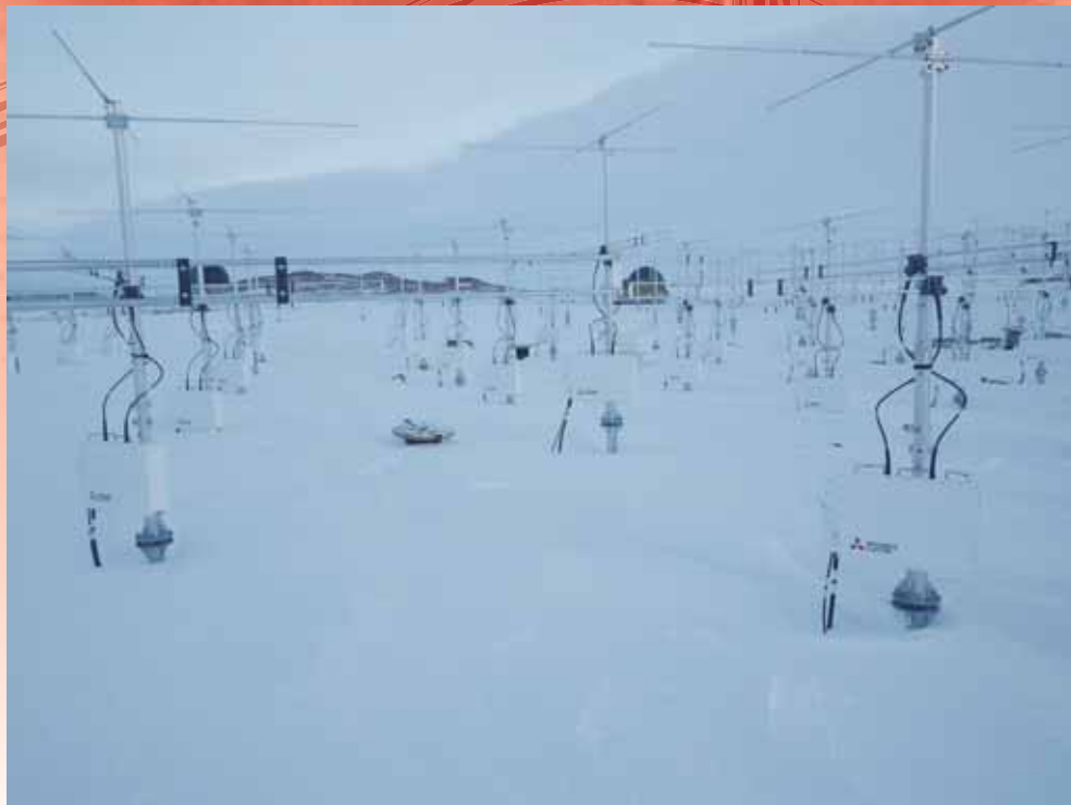
南極昭和基地で対流圏と成層圏の本格観測を開始した PANSY レーダーのアンテナ群 ～研究ニュース「南極最大の大型大気レーダーが本格観測開始」より～
