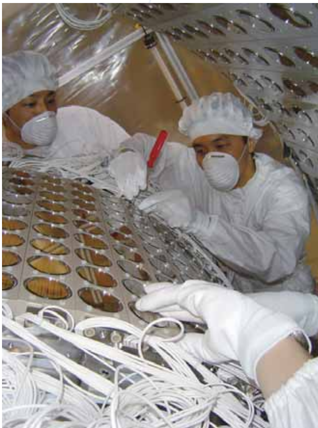
本研究のために開発された実験装置のひとつ、液体キセノンガンマ線測定器を組み立てているところ。2.7トンの液体キセノンの光を、取り囲んだ光電子増倍管がとらえる。
