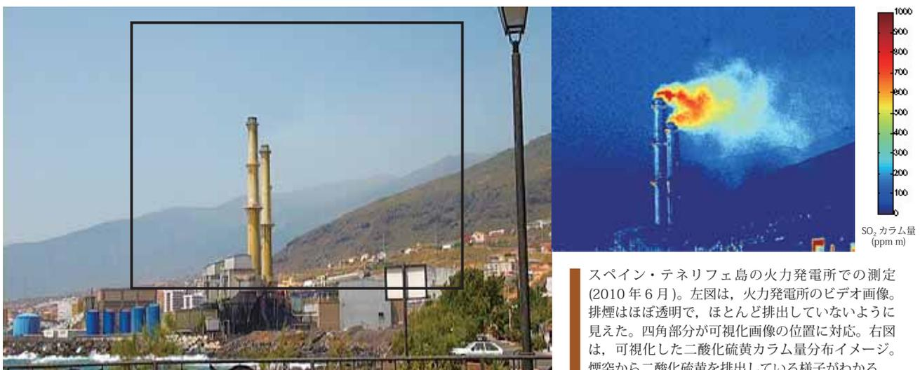
スペイン・テネリフェ島の火力発電所での測定（2010年6月）。左図は、火力発電所のビデオ画像。排煙はほぼ透明で、ほとんど排出していないように見えた。四角部分が可視化画像の位置に対応。右図は、可視化した二酸化硫黄カラム量分布イメージ。煙突から二酸化硫黄を排出している様子がわかる。
