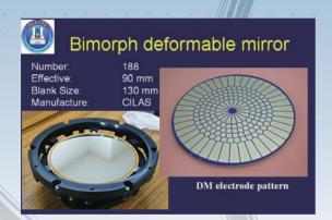
補償光学系の心臓部にあたる可変形状鏡。直径 130 mm の鏡の裏には右図のような配置の188 個の電極があり、それらの電圧を高速駆動制御することにより、鏡の表面が光の波長程度の振幅で凹凸して、光波面の乱れを実時間補正する。国立天文台チームによる電極配置の最適化設計をもとにフランスの光学会社で特注製作した。
