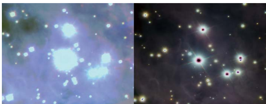
図 2：（左）1999 年にすばる望遠鏡で撮影したオリオン大星雲のトラペジウム領域。（右）2006 年に補償光学系をつけて撮影した同じ領域。解像度が 10 倍向上している。
