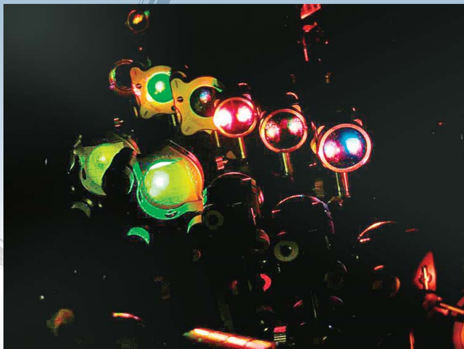
超広帯域極短パルス光発生装置にて生じた正分散の高精度補償装置。レーザー光が、負分散ミラー（多層膜ミラーの各層の膜厚を調整する事で、ガラスなどの材料がもつ分散とは逆の分散をもつミラー）を複数回反射することによってフーリエ限界に近い極短パルスを発生することができる。
