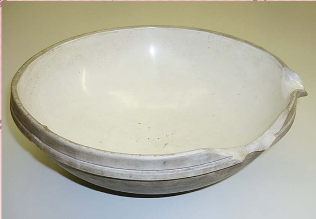
a: 抽出の際に用いられた英国製大蒸発皿 (化学専攻大越研究室所蔵)。
