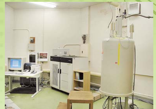
500 MHz 超伝導核磁気共鳴測定装置
