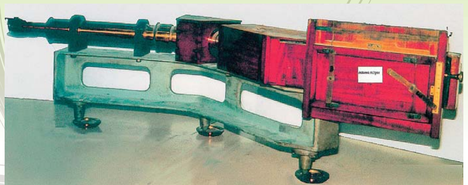
戦前から戦後にかけて化学教室において使用されたプリズム式写真分光器
