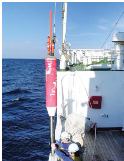
図1：マイクロスケールプロファイラーを用いた深海乱流の観測
