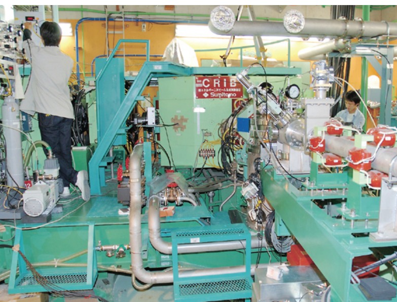
図 3：CRIB 装置。天体現象では、極めて低速で動く不安定短寿命核が反応を起こすので、それに近い条件で実験を行う。
