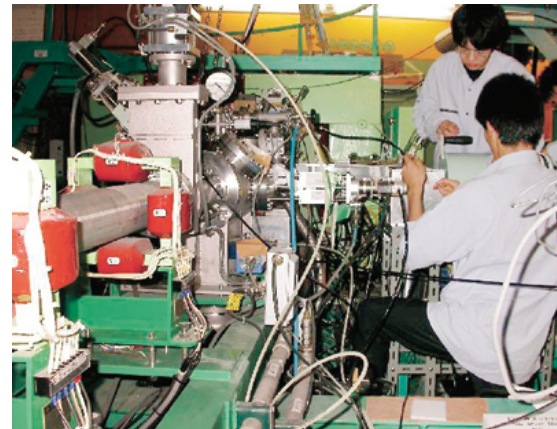
図 1：物理学科 3 年生の学部実験風景。実際に先端研究に使われているサイクロトロンを用いて、原子核によるアルファ粒子の散乱や、回転バンド・スペクトルの検証をする。
