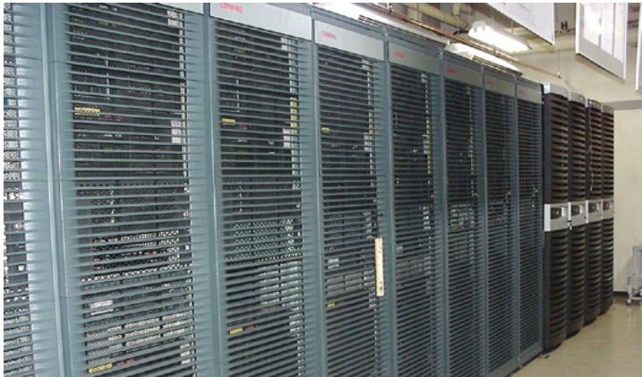
図 7：理論計算用並列計算機。180 台の CPU からなり、不安定原子核の量子構造シミュレーション計算を行う。科研費特別推進研究（代表者大塚孝治）による物理学専攻との共同事業。
