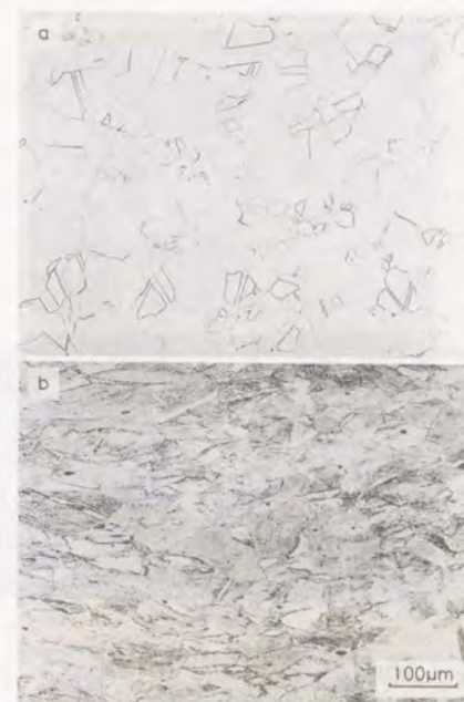
写真6.4 BL鋼の4Kでの引張試験材のマイクロ組織。a) 弾性変形部、b) 45%変形部
