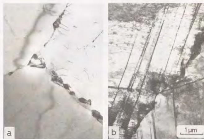
写真5.4 N6鋼時効材の透過電顕写真。a) 未変形材、b) 8%変形材
