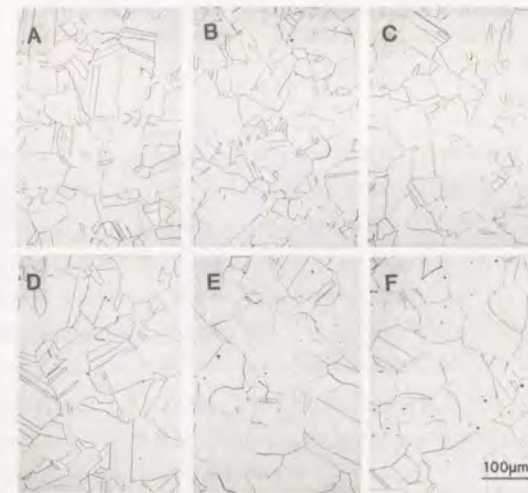
写真6.8 A～F鋼溶体化材のマイクロ組織。
