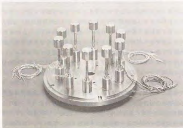
写真2.1 ターレットディスク上に装着された引張試験片外観。
