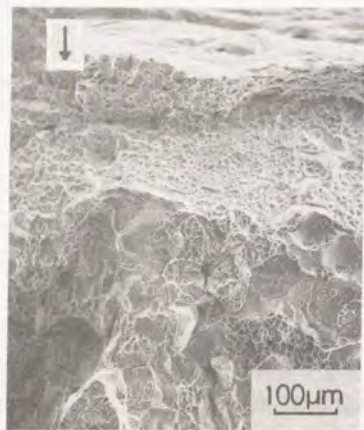
写真3.6 SUS304L時効材の4Kでのシャルピー破面。矢印位置は機械加工ノッチ部で亀裂は矢印方向に進展している。
