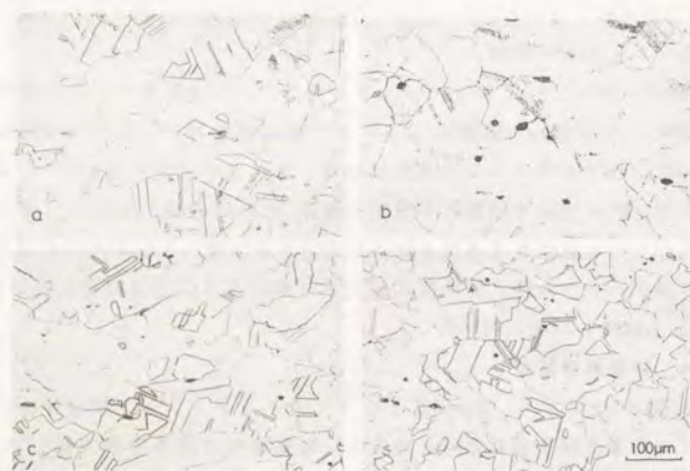
写真4.1 SUS321, 347の溶体化材と直接時効材のミクロ組織。
