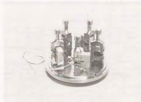
写真2.2 ターレットディスク上に装着されたコンパクトテンション試験片外観。
