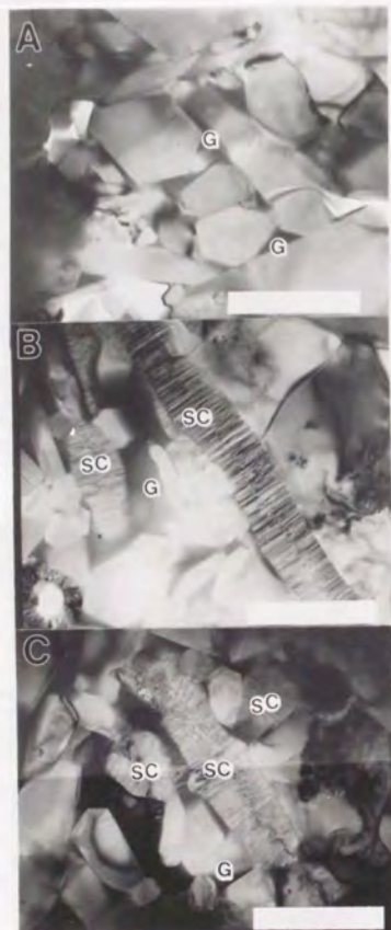
図4.18 SiC-whisker/窒化珪素複合体のTEMによる微構造形態 (A: SSN, B: SiC-w/SN, C: SiC-w/SN, Bar=1 μm)
