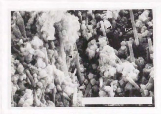
図4.5 SiC-whisker/TZP複合体の微構造 (Bar=10μm、矢印はSiC-whisker)
