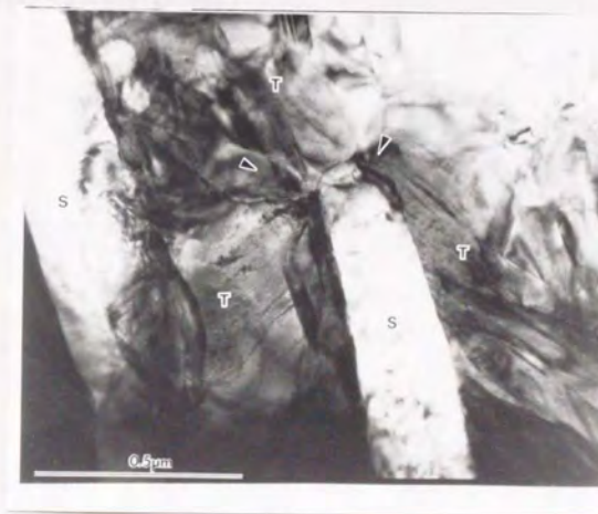
図4.7 SiC-whisker/TZP複合体のTEMによる微構造観察 (S C : whisker, 矢印: 転移ゾーン)
