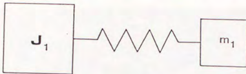
Fig. 4.13 低剛性アームのバネ・マス近似モデル
