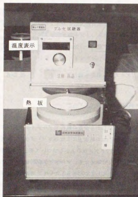
図 5-7 ゲルタイム試験器
