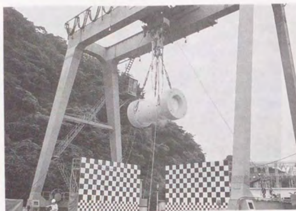
9 m 落下試験前（吊上状態）
