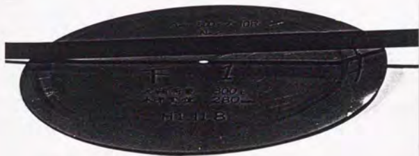
写真2.5 A_{40} -500×7-10R 変形率400%終了後 の変形した中間板 (ボンデ鋼板 t=3.2\text{mm} )
