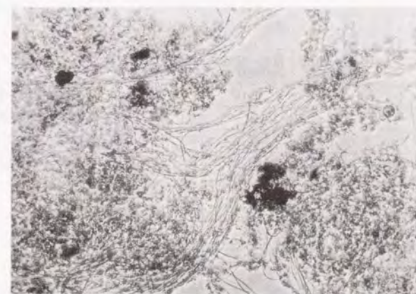
写真5-4 標準活性汚泥法系列活性汚泥(4月8日)
