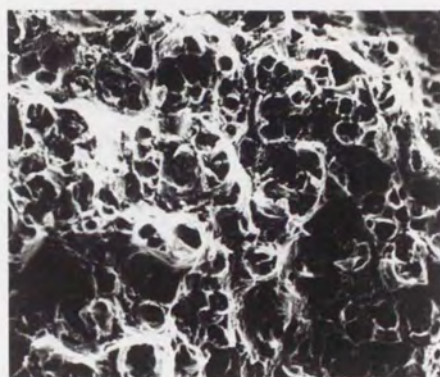
き裂進展開始直後 (引裂き型破壊)
