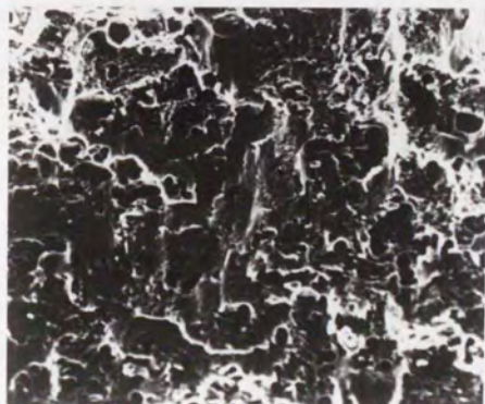
平面応力型破壊
