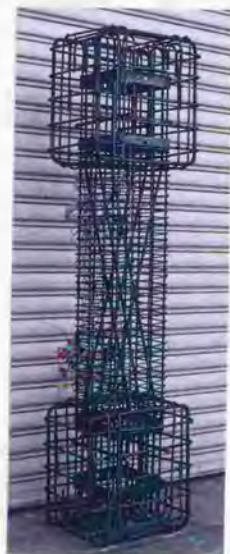
写真6.1 試験体の配筋状況
