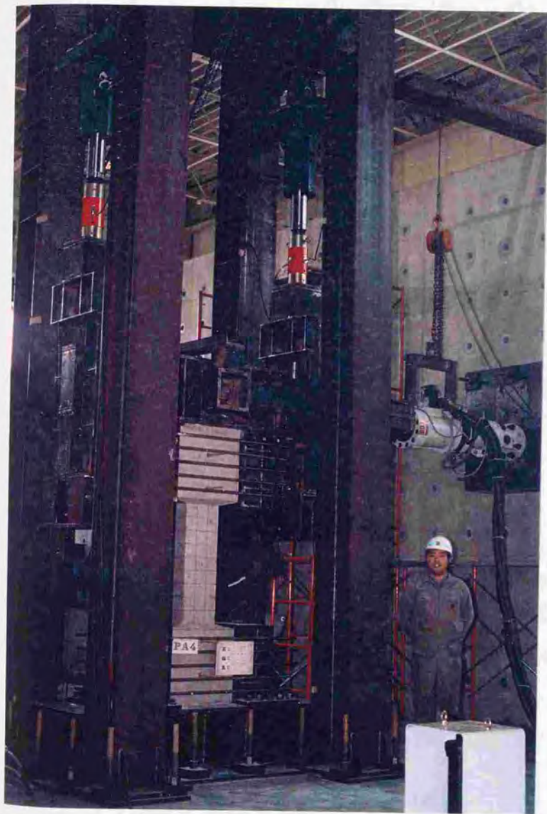
写真5.2 非対称曲げモーメント載荷装置
