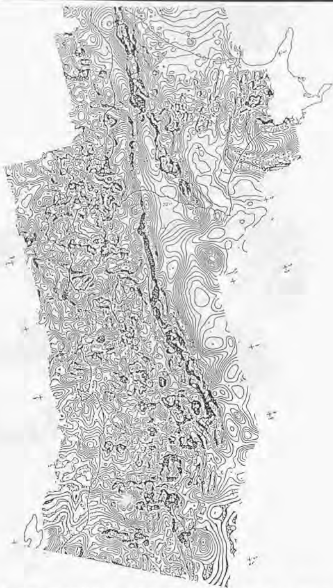
図2-1 a 我が国陸域、周辺海域における空中磁気データをコンパイルし、得られたコンパイル空中磁気図（北海道、東北地域） （コンター間隔；25ガンマー） コンターが密の地域は、地下浅所に、あるいは磁性の強い磁性岩体が存在することを示す
