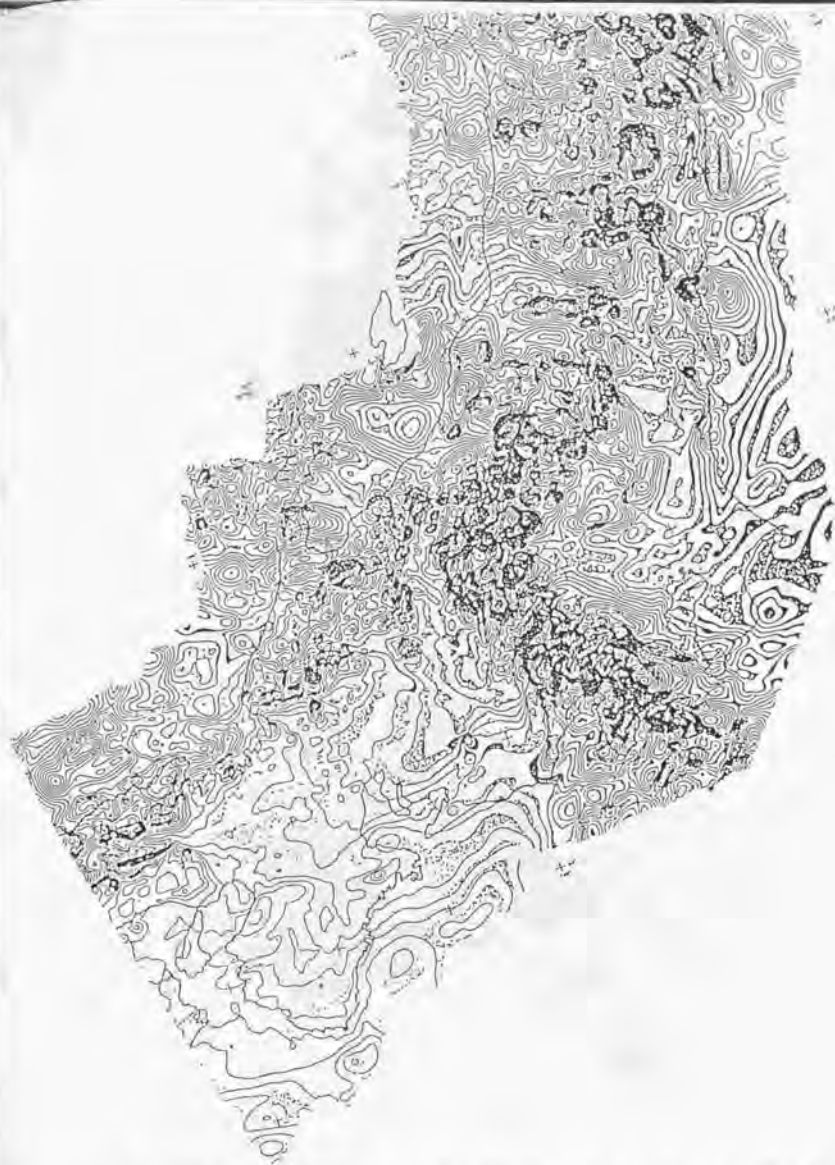
図2-1 b 我が国陸域、周辺海域における空中磁気データをコンパイルし、得られたコンパイル空中磁気図（東北南部、関東、中部、近畿地域）（コンター間隔；25ガンマー） コンターが密の地域は、地下浅所に、あるいは磁性の強い磁性岩体が存在することを示す
