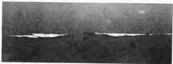
(a) M1 の摩耗粉断面
