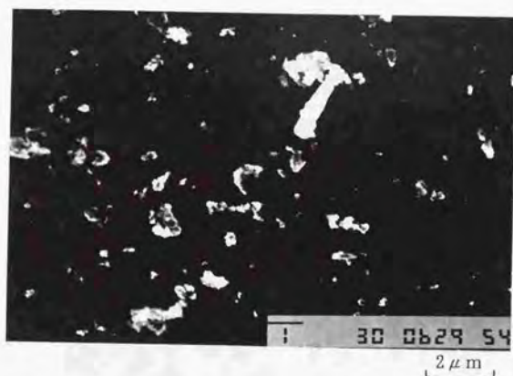
図 6.10 摩擦面外に排除された摩耗粉の形状 (M1)
