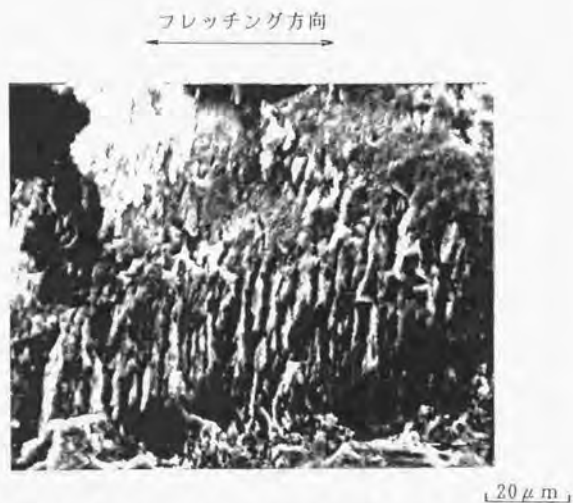
図7.20 摩耗痕のピット内にみられる波状模様の例
