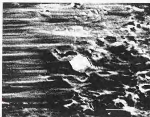
図 6.11 摩擦面にみられるピットと 遊離しかかっている粒子 (M1)
