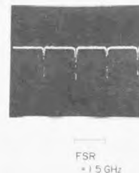
図 5.10: レーザ発振時の FSR 特性
