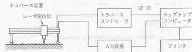
図3.27 路面粗さ計のブロックダイアグラム
