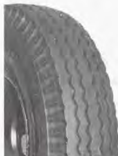
(a) バイアスリブタイヤ サイズ : 10.00-20 ピッチ長 : 57mm
