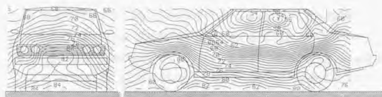
図2.1 乗用車から放射される音響インテンシティのコンターマップ （4気筒1800ccガソリンエンジン、2000rpm、停止時、無負荷）
