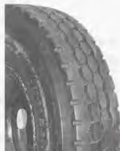
(c) ラジアルリブラグタイヤ サイズ : 10.00R20 ピッチ長 : 68mm
