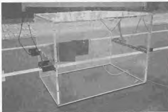
図3.30 路面の吸音率測定用に試作した小型残響箱
