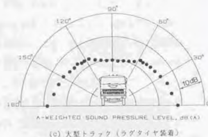
図A.4 音圧レベルの2乗積分値による各車両の指向性パターン
