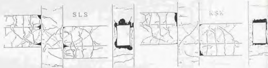
(d) はりの圧壊が比較的軽微
