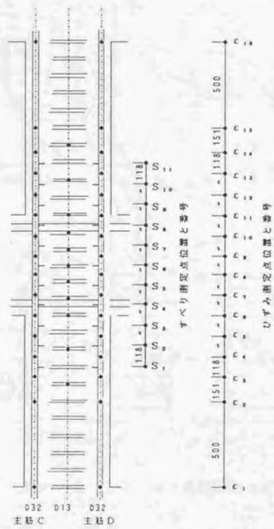
図 2. 2. 6 柱のひずみ、およびすべり測定点
