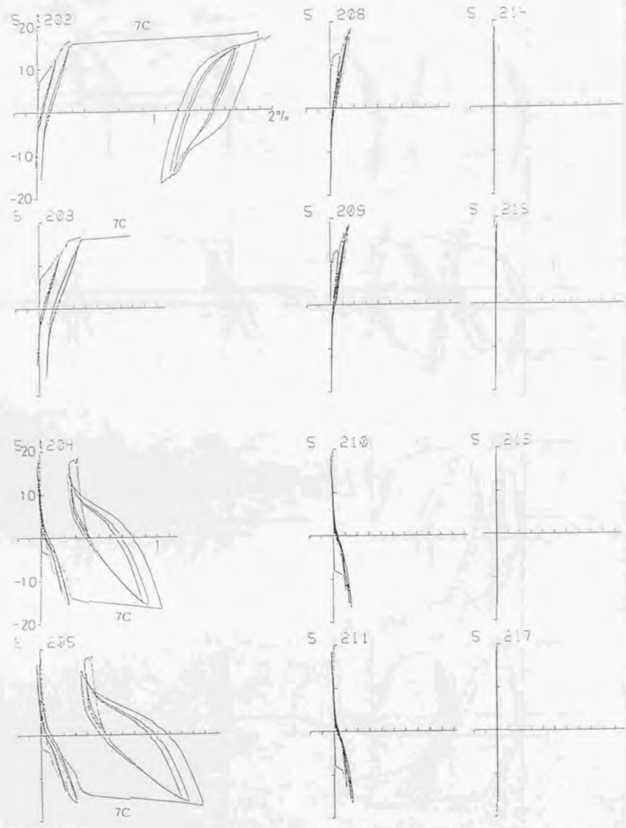
図2.4.17 はり主筋の荷重-ひずみ度曲線(d)
