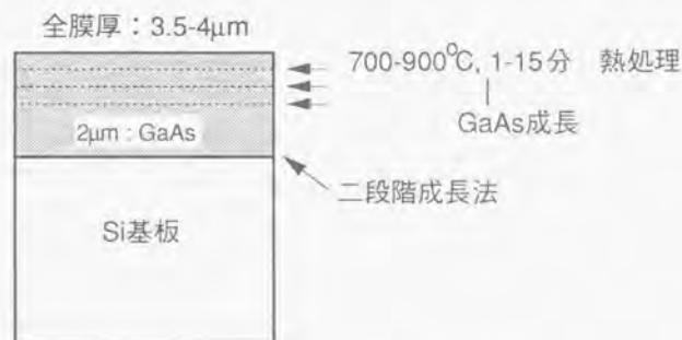
図2.3-1 熱サイクル成長法の説明図
