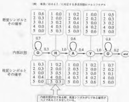
Fig. 8.7 多系列の隠れマルコフ過程を用いた視聴覚融合による音声認識
