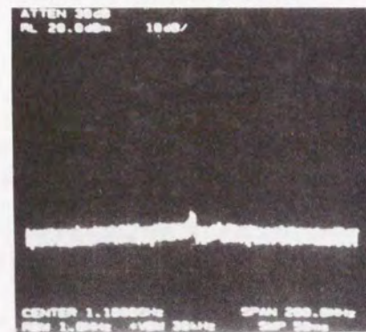
(b) チャンネル2、3がFSK変調されている時 (560 Mb/s、 2^{15}-1 疑似ランダム信号、変調指数=0.22)
