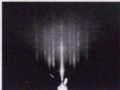
図5-6 白雲母基板上にNbSe 2 を成長したときのRHEEDパターンの変化
