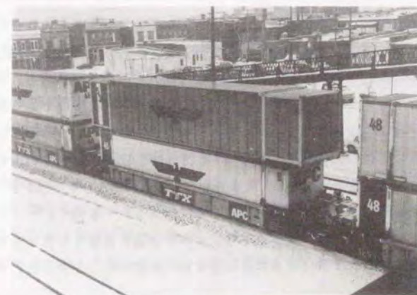
写真3-1 米国に流通する超大型コンテナ(48ft,53ftの例) 1992年11月、嶋野崇文氏(著者の指導学生)撮影
