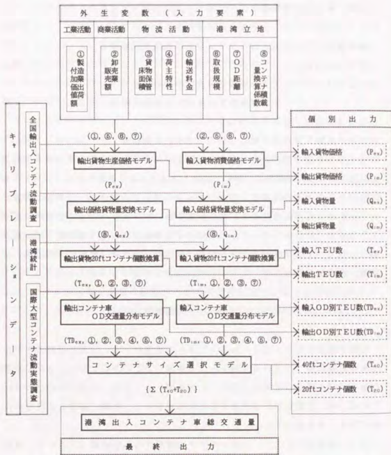
図4-19 シミュレーションモデルの構造 3. 4節及び4. 6節の分析結果からコンテナサイズ 選択モデルは輸出入で共通となっている。
