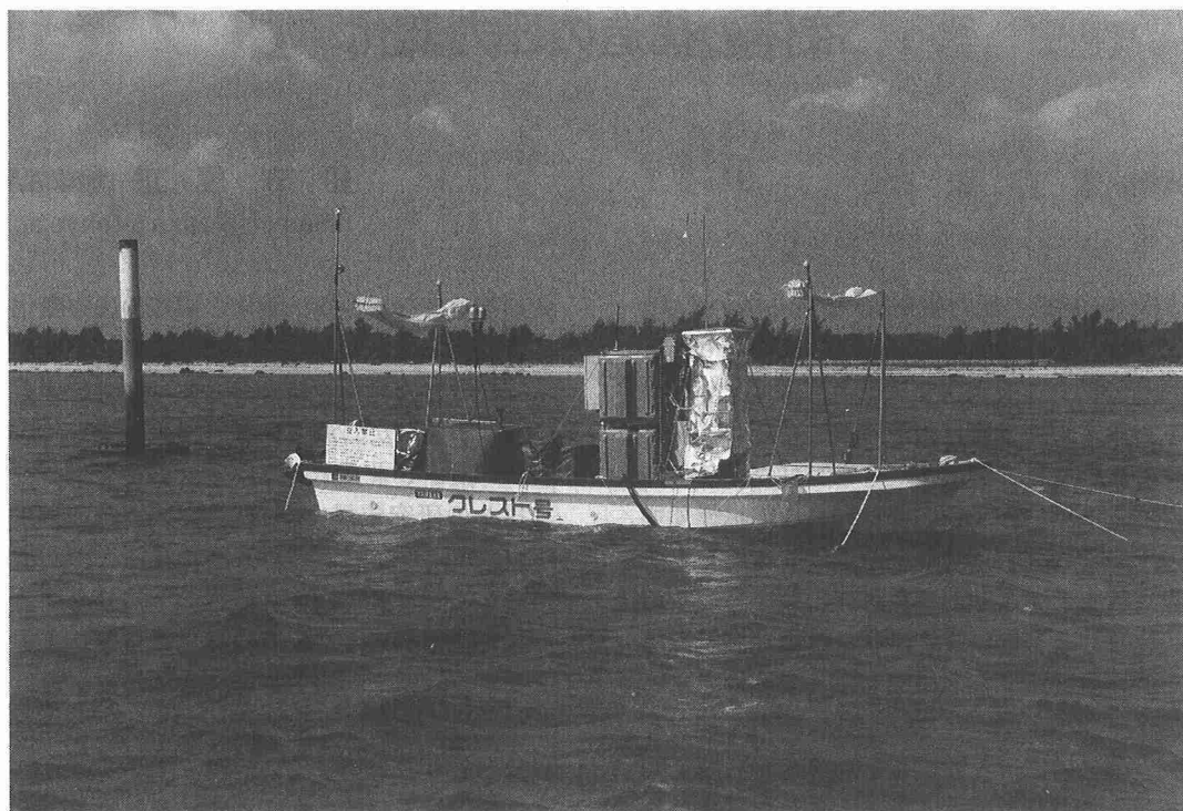
写真 石垣島白保サンゴ礁上に係留され、サンゴ礁海水中の \text{CO}_2 系の計測を行うクレスト号。
