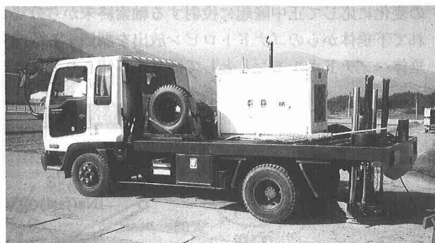
写真：震源車。荷台中央の白い箱は油圧発生装置。荷台最後部に付いている油圧バイブレーターで路面を揺する。長野県神城盆地にて。
