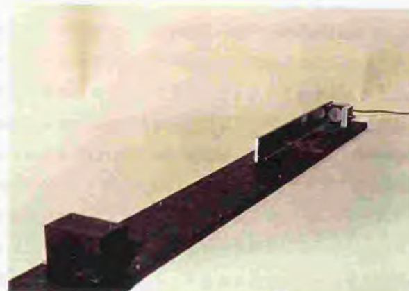
図5.6 音速補正センサの外観図
