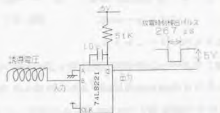
図4.23 放電時刻検出回路
