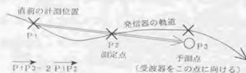
図6.1.2 位置計測におけるフィードフォワード制御
