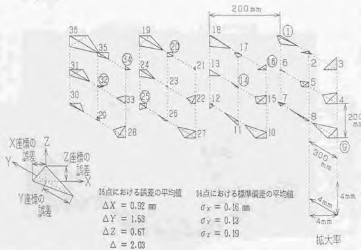
図9.17 Pana Roboの静的位置計測結果
