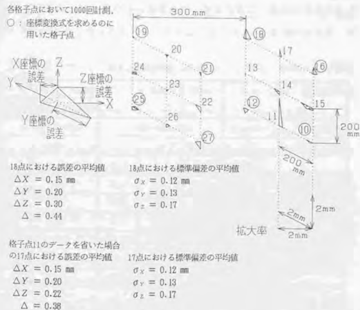
図7.12 測定空間を制限した場合の測定誤差分布図(音速推定法使用)
