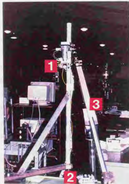
1: 受波器4 2: 受波器2 3: 相互距離測定専用音速補正センサ
