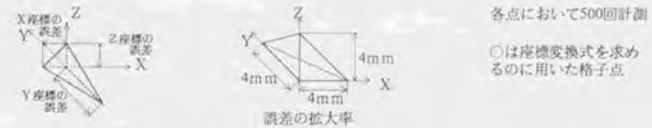
図9.21 ムーブマスターの静的位置計測結果
