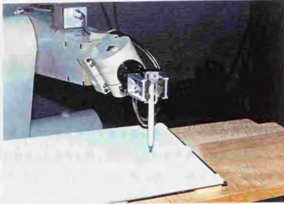
図10.5 ペン書きによる軌道測定実験風景
