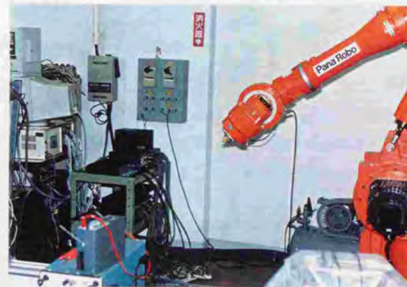
図9.15 Pana Roboの静的位置計測実験風景
