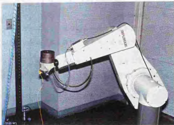
図10.12 負荷重量を加えた場合の軌跡計測実験風景
