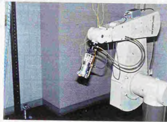
図9.12 静的姿勢計測実験風景
