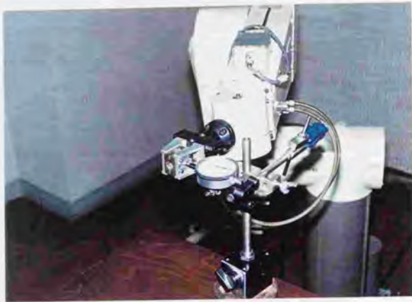
図9.5 ダイアルゲージによる位置繰返し精度検証実験風景
