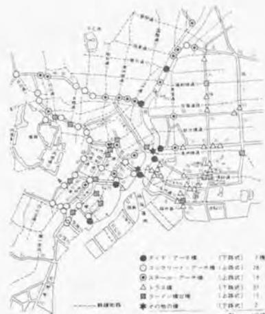
図 3.3.58: 復興橋梁のシンボル橋配置図 [13](p118)
