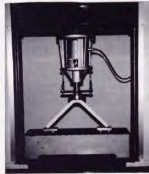
成形合板の加圧角開き試験
