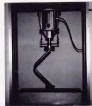
金属パイプの加圧角曲げ試験
