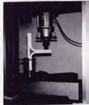
成形合板のT型接合曲げ試験
