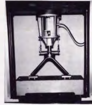
金属パイプの加圧角開き試験
