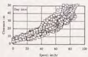
図4.4 追従走行実験による5人の運転者の車間距離-走行速度関係 (昼間および夜間のケース)
