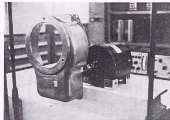
図 8.8: スパイラルケースの加振試験
