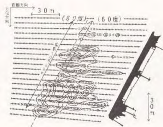
図6.3 港湾監視用レーダ(水平ビーム幅0.25度)の映像
