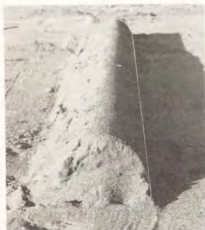
図3-16 人工凹凸（かまぼこ型）
