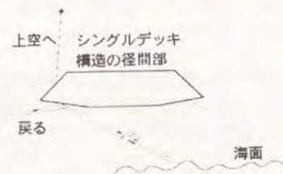
図. 付2-1-19 シングル・デッキ構造の径間部の下面傾斜している部材によるレーダ偽像
