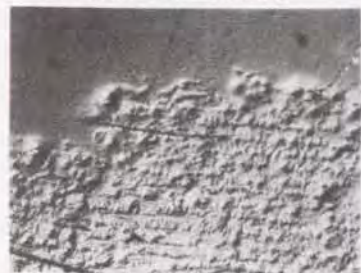
(e) 膜面の浮き (Si基板+Ag+保護膜)
