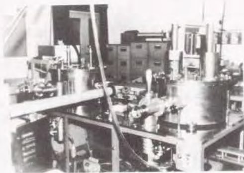
図3. 7 平衡方式による吸収率測定装置
