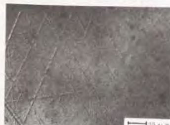
(d) K5ピッチ、アルミナ 0.06 \mu\text{m} 、 プロピレングリコール+エタノール、 1 \text{ g/mm}^2
