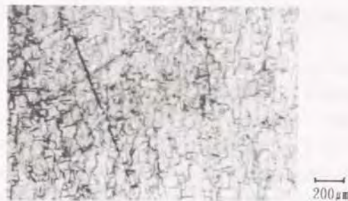
図3.18 加工液によるエッチング作用が強すぎる場合のKCl加工面
