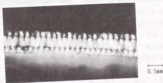
図4.24 分割光の表裏面同時照射によるセラミックのスクライビング
