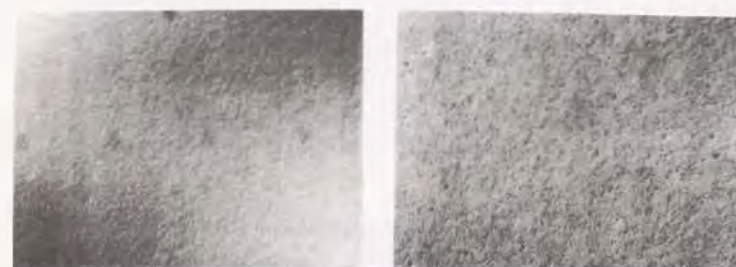
Snポリリッシャとダイヤモンドペースト1μmによる加工面
