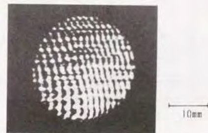
図2.9 WのCBN1000研削加工面の干渉縞
