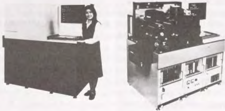
図1. 7 新聞社用大型平面スキャナの例 (電子網掛装置)
