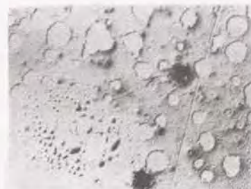
(a) 膜面の浮きとはがれ (Si基板+Ag+保護膜)
