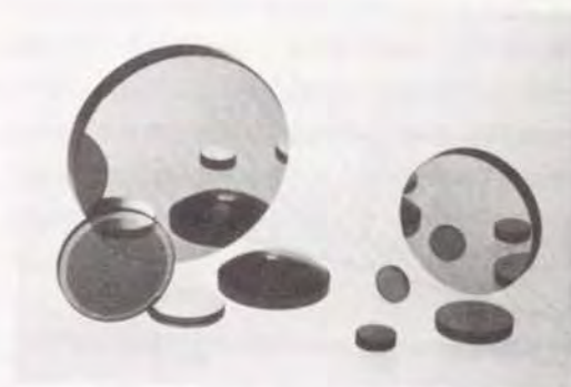
図3. 27 試作した各種のCO 2 レーザ用光学素子
