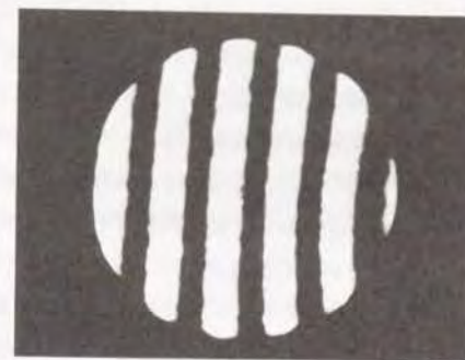
図3. 26 KCl平面窓のレーザ干渉計による形状測定結果 (直径100mm)
