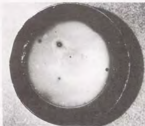
図2. 1 典型的な反射鏡の損傷状況 (Cu+Niめっき基板、Ag+保護膜蒸着)
