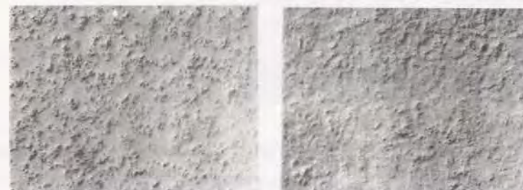
200 μm クロスポリリッシャとダイヤモンドペースト1μmによる加工面
