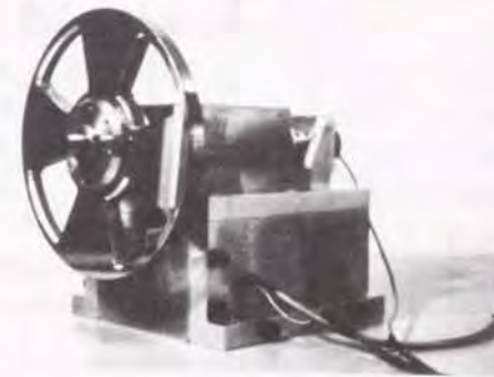
図4. 12 チョップミラー機構部の外観 (チョップミラー外径: 220mm)
