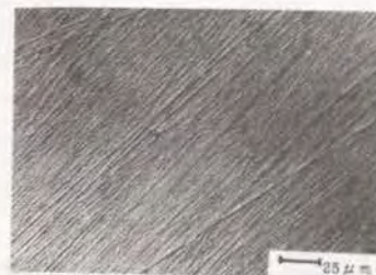
(a) K5ピッチ、DP 1 \mu\text{m} 、 エタノール、 1 \text{ g/mm}^2
