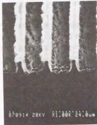
図5. 11 GeのRIE加工実験における加工面の例 (マスク除去前)
