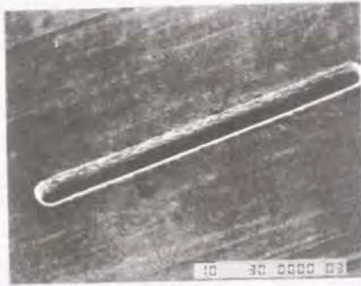
図8. 40 電極の2種の運動の組合せによって加工を行ったスリット
