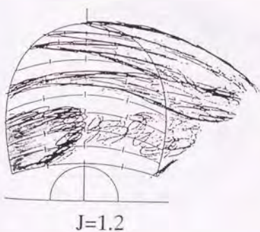
Fig.3.4.12 SRII-IIプロペラのキャビテーション・パターン・のスケッチ ( \sigma_v=0.4 )
