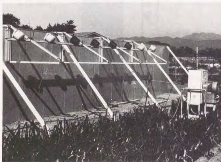
Photo.6.2: 騒音源、2次音源の設置の様子
