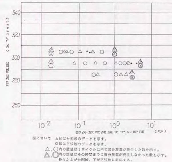
図5-20 外鉄形セクション間モデルの台形波V-t特性
