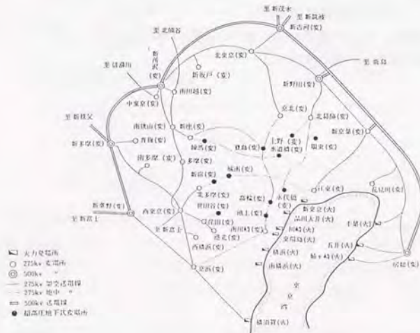
図2-31 東京電力の都内275kV地中系統
